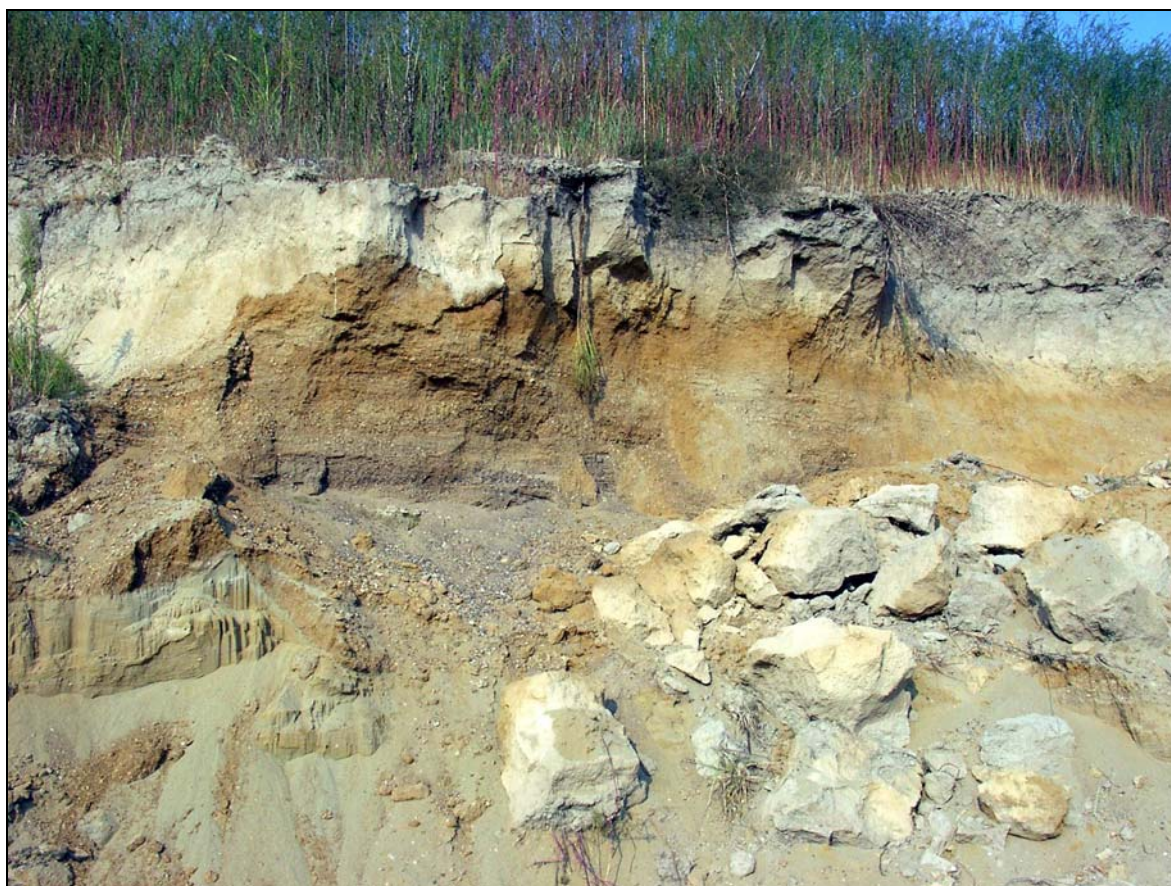
Fig. 2 Sequenza litologica della scarpata di scavo posta in corrispondenza dell'Ambito Estrattivo "C101 / g101 / PV" del P.C.P.
